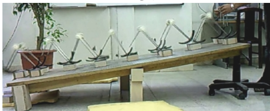
شکل ۸: مدل با دو وزنه‌ی ۲۰۰ گرمی اضافه شده در بالا تنه در حال قدم‌زنی بر روی شیب اولیه ۰/۱ رادیان
