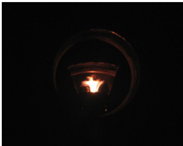
شکل ۵- شعله‌ی تشکیل شده توسط مشعل درون محفظه احتراق
